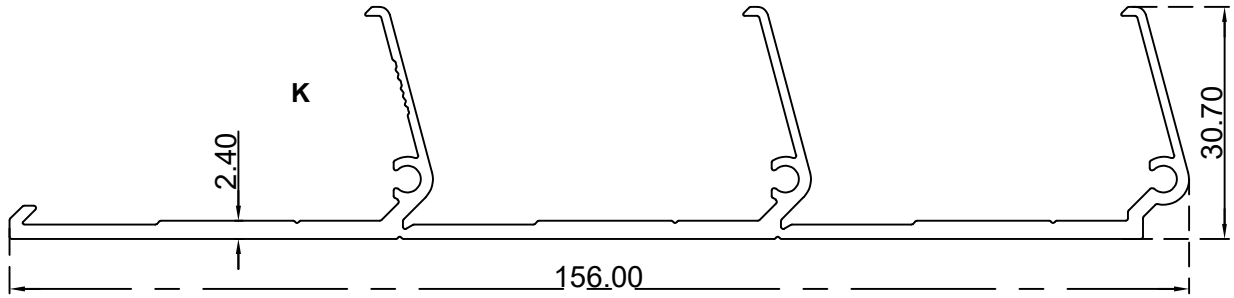
قاعدة رفراف 55 ملم الرقم التسلسلي للصنف: BLT4643 الوزن 1.329:(Kg/m)
